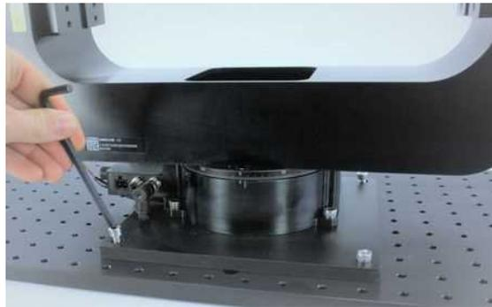
ジンバルの電源投入前に、5mm の六角レンチを使用して、付属の 4X M6 ネジで取り付け面に固定して下さい。最大トルク仕様は 6 N·m です。
