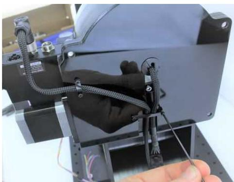
ストラップを使用してケーブルを固定し、M2 ネジを手で締めます。
