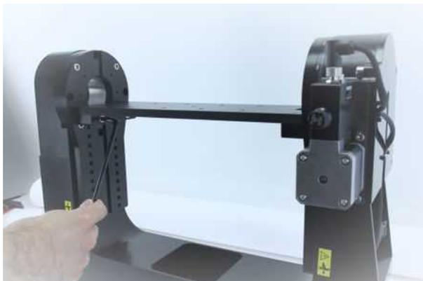
5 mm の六角レンチを使用して、クロスメンバープレートフィートの 4 つの M6 ネジ (両側に 2 つ) を取り外して下さい...
