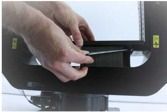
プレートの脚の部分エレベーションマウントに手で締めて固定して下さい。ヒント：梱包材のフォームをサポートとして使用し、プレートが誤って落下した場合にジンバルアームを損傷から保護してください。これらのネジの最大トルクは 4.2 N·m です。
