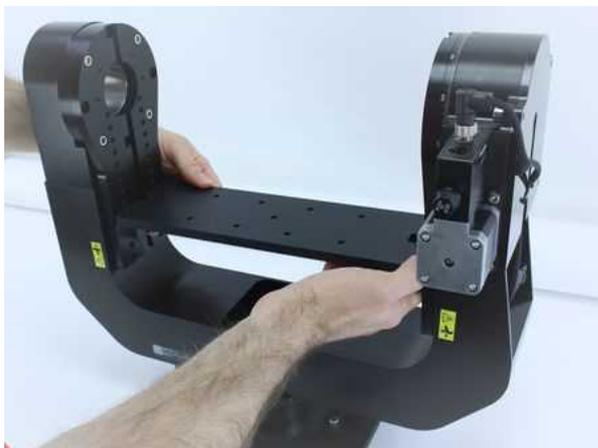
慎重に、プレートを目的の位置までスライドして、下げて下さい。プレートを下げるときは、プレートを水平に保ってください。
