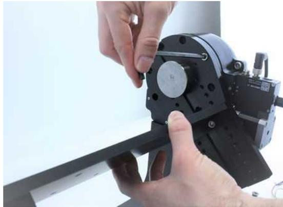
マウントを再度取り付けたら、4本の M6 ネジを再度締めてください。
