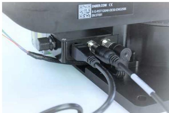
電源ケーブルを接続して、X-USBDC ケーブル M8 コネクターを X-RST-E ステージ下段の丸形プラグに接続してください。
