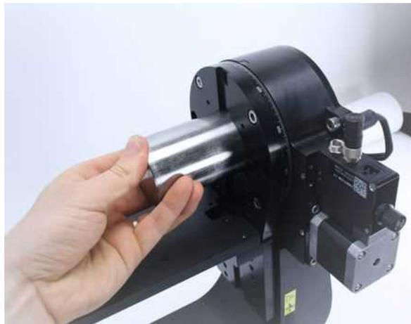
2 インチの精密位置合わせ（アライメント）ピンを昇降軸ステージの開口部に挿入します。必要に応じてクロスメンバープレートを下げて開口部の別の取り付け穴位置の全部が良く見えるようにしてください。
