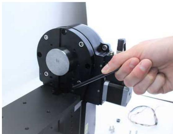
5 mm の六角レンチを使用して、4 つの M6 ネジを外してください。
