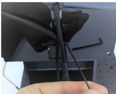
1.5 mm の六角レンチを使用して、ストレインリリーフストラップの片側にある M2 ネジを外します。
