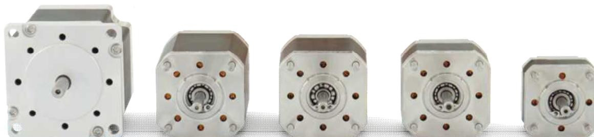
モデル D モータは、2相ハイブリッドステッピングモータであり、さまざまな標準サイズとトルク定格で利用できます。標準モータは、1回転あたり 200 フルステップを提供し、 $1 \times 10^{-10}$  mbar 未満での使用、および  $-65^{\circ}\text{C}$  ~  $+175^{\circ}\text{C}$  の動作温度に適しています。拡張低温範囲 ( $-196^{\circ}\text{C}$ ) バージョン、耐放射線バージョン ( $1 \times 10^6$  Gy)、シャフトの変更、およびハイブリッドベアリングはすべて利用可能なオプションです。
